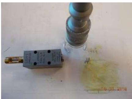
Blocage du piston sur un doseur double ligne DDM1 Delimon - Vue d'ensemble- microscope x50
